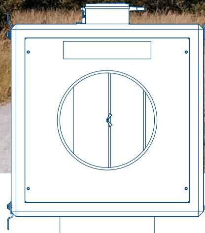
**AIR MIX KIT** sfrutta le condizioni di temperatura dell'aria esterna per usufruire di un'aria miscelata e lavorare senza l'utilizzo di un refrigeratore: in questo modo si attiva la funzione free-cooling e si arrestano automaticamente i compressori, utilizzando una fonte energetica gratuita ma controllata con una precisione molto rigorosa. Con l'utilizzo di AMK è quindi possibile ridurre in maniera considerevole i consumi energetici a tutto vantaggio dei costi.
